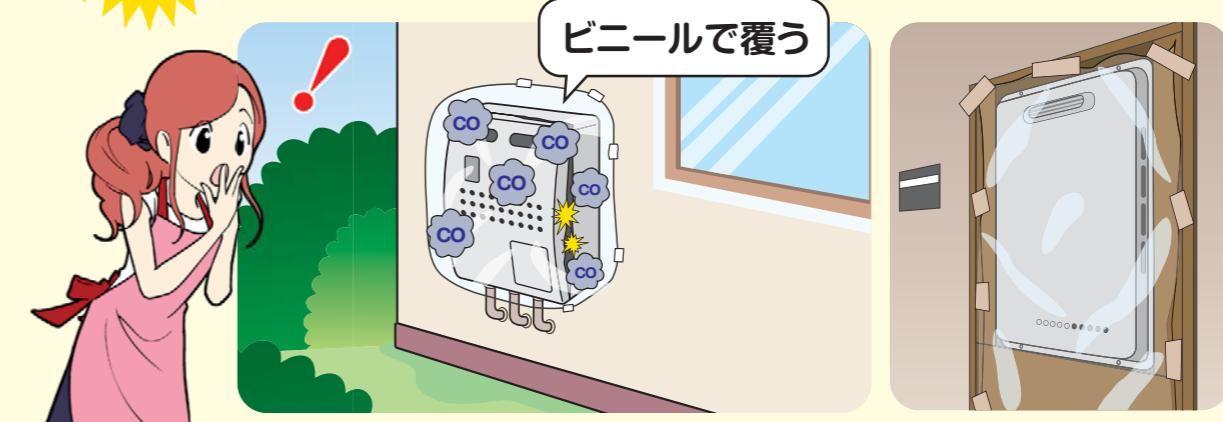
ガス機器が燃焼できなくなり、未燃ガスが滞留
